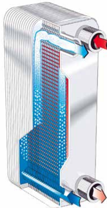
Zasada przepływu w parowniku
